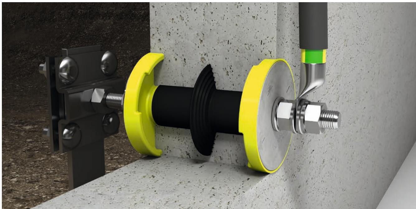
Erdungsdurchführung HEA-IS-M12: auf der einen Seite Anschluss eines Flachstahls über Kreuzklemme Z-KG-M12 und auf der anderen Seite Anschluss eines Erdungsleiters über den Anschlussbolzen Z-B-M12.
